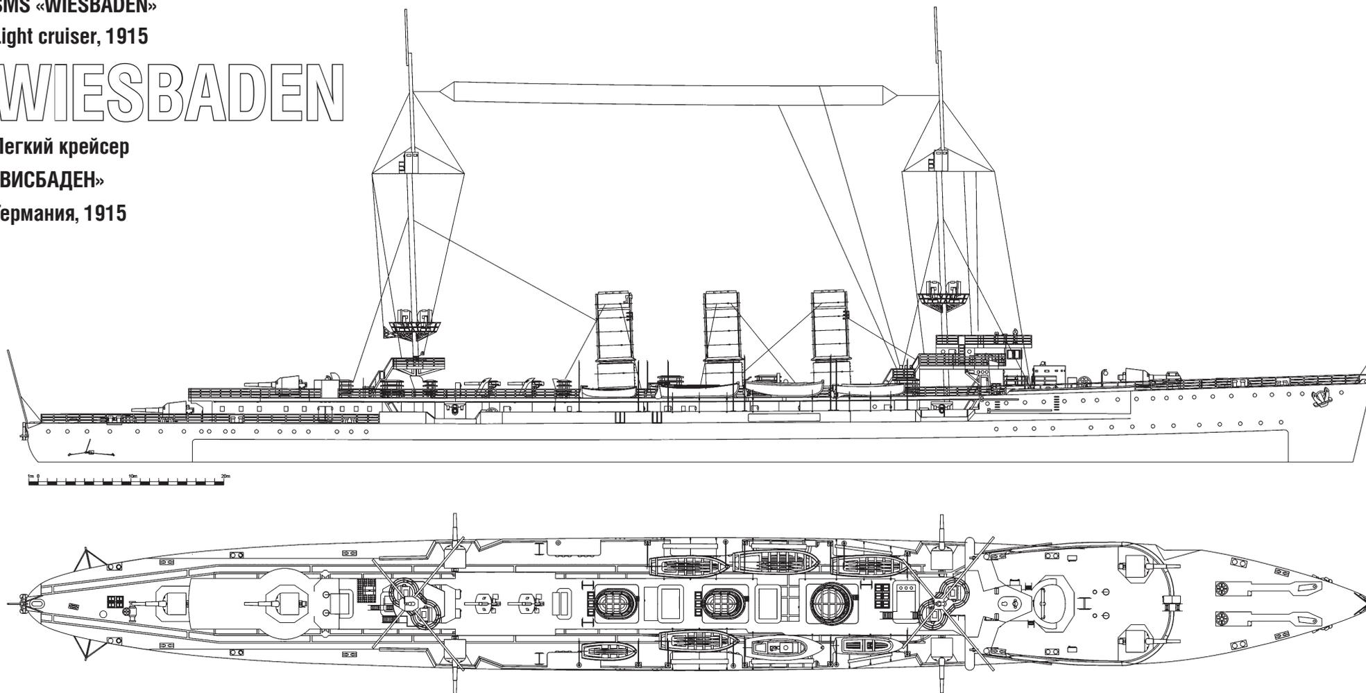
Головной корабль в серии из двух легких крейсеров германского флота, ставшей развитием типа «Граудениц». Стал первым германским легким крейсером, изначально получившим вооружение из 150-мм орудий, а также первым оснащенным турбинами с непрямой передачей на
